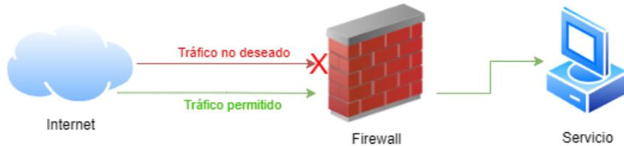
**Figura 4.1.** Ejemplo de funcionamiento de un firewall.
