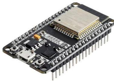
**Figura 6.2.** Imagen ilustrativa de un ESP32. Recuperado de: <https://www.amazon.com/-/es/DIYmall-ESP32-WROOM-32-desarrollo-ESP-32S-Arduino/dp/B084KWNMM4>.
