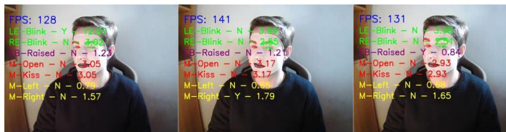
**Figura 8.7.** Capturas tomadas con la cabeza en ángulo de aproximadamente 30 grados con respecto a la cámara. Los gestos detectados incluyen el guiño del ojo derecho, una mueca hacia la derecha y levantar las cejas.
