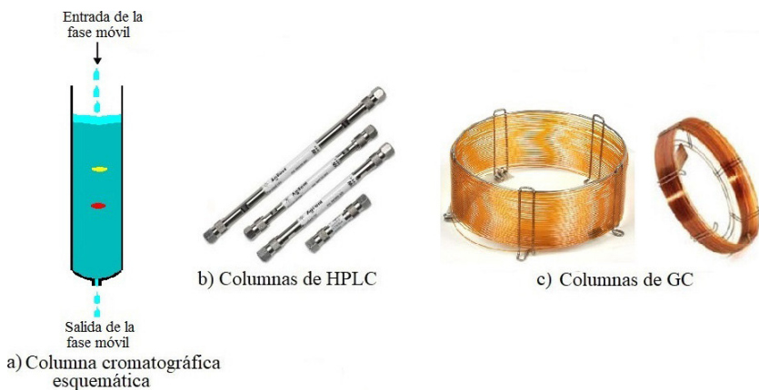
Figura N.º 3. Columnas de cromatografía.
