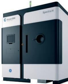
Con un volumen de construcción ampliado y la capacidad de fabricar a temperaturas superiores a 1000 ° C, la Arcam EBM Spectra H está abriendo nuevas oportunidades para la producción de piezas de alta complejidad más grandes y rápido que nunca.
