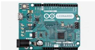
El Arduino Leonardo es una placa de microcontrolador basada en el ATmega32u4. Tiene 20 pines de entrada / salida digital (de los cuales 7 se pueden usar como salidas PWM y 12 como entradas analógicas), un oscilador de cristal de 16 MHz, una conexión micro USB, un conector de alimentación, un encabezado ICSP y un botón de reinicio.
