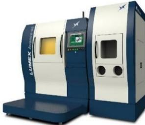
Con un tamaño superior a su predecesora, la LUMEX Avance-60 se presenta como la solución de fabricación aditiva híbrida en metal con mayor volumen de construcción del mercado. La capacidad de fabricar un componente metálico de gran tamaño y alta complejidad, combinado con el acabado superficial propio de un proceso de mecanizado, hacen de esta solución un gran aliado para la producción industrial.
