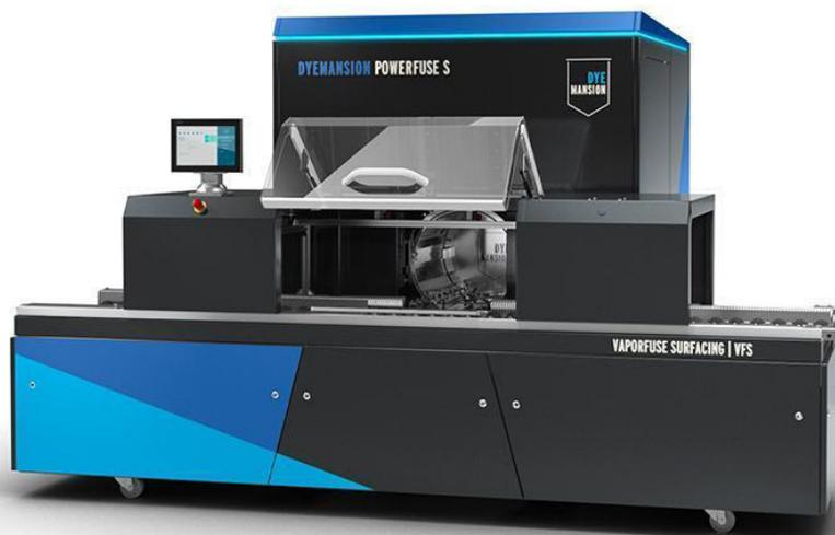
VaporFuse Surfacing (VFS) ofrece piezas selladas y lavables con superficies similares a moldeo por inyección. La rugosidad de la superficie se reduce al mínimo. Toda la cámara de proceso se inunda con vapor mientras se somete al vacío. Esto asegura un procesamiento reproducible de geometrías complejas y superficies internas. VFS funciona para todos los plásticos habituales y, en particular, para polímeros flexibles como el TPU, para los que las técnicas mecánicas no son adecuadas.
