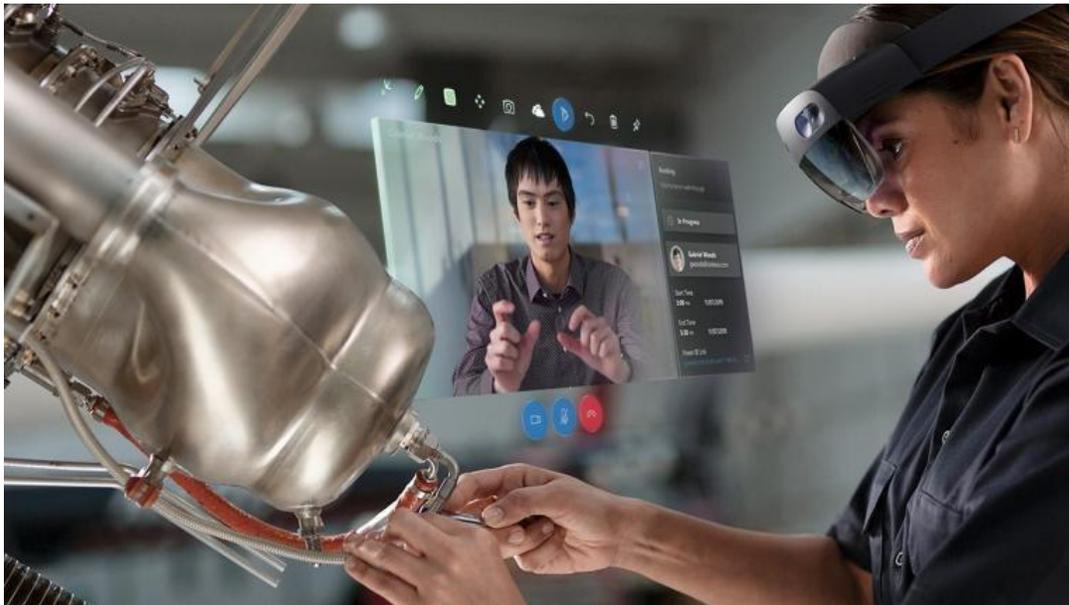
Este dispositivo integra el sistema operativo Windows 10, está diseñado para explotar las capacidades de Windows Holographic. Las lentes utilizan sensores avanzados con un monitor óptico 3D HD y un sistema de sonido espacial, entre los sensores se encuentra una cámara de profundidad con un campo de visión de 120° x 120°. Peso 566 g.
