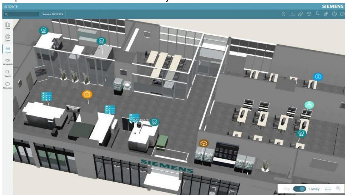
Se pueden probar sistemas de automatización antes de su lanzamiento, mejorar la seguridad y comodidad en el trabajo ya que la simulación incluye a las personas, también permite programar y simular operaciones de robótica.
