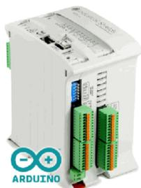
Este autómata dispone de **hasta 58 Entradas/Salidas**, se puede programar a través del puerto USB o configurar el autómata para ser programado de forma remota mediante el puerto Ethernet. Permite la utilización del Monitor (en el Arduino IDE) para ver el estado de todas las variables, entradas, salidas, etc. Utiliza **protocolos estándar Industriales** como son **Ethernet IP y Modbus TCP** y se pueden añadir comunicaciones adicionales como **WiFi**.
