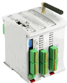
Gama de PLCs ideales para monitoreo remoto, registro de datos y acceso remoto, diagnóstico y control, utilizando mensajes de texto cortos (SMS). Puede enviar a números de teléfono predefinidos. El envío de mensajes SMS se puede activar mediante el cambio de estado de entrada binaria, alcanzando umbrales de alarma, cambio de estado de marcador, contadores y relojes.
