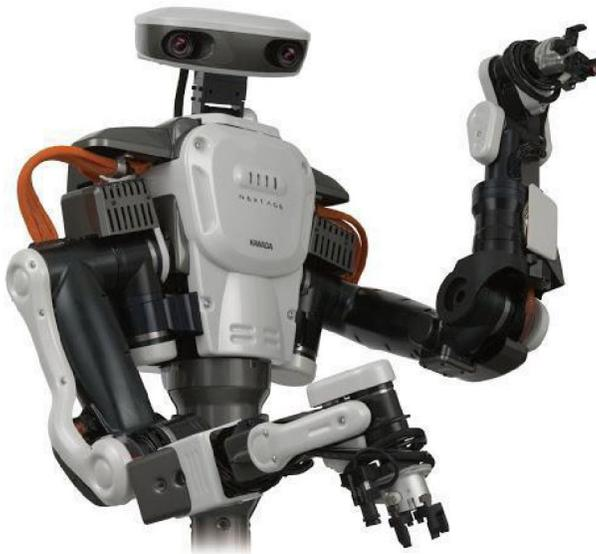
Es un robot colaborativo que supera los 173 cm de altura, con base prácticamente cuadrada con sus 58 x 56 cm y con un peso de 130 kg. Posee un software de ROS-Compatible, e incorpora un software y un controlador Open Source fabricado por TORC (Tokyo Open Source RoboticsKyokai Association). Nextage tiene instaladas cuatro cámaras de visión Artificial, dos de ellas en la cabeza y una en
