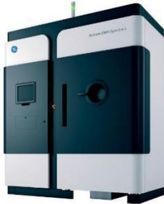
Debido a una mayor potencia del haz a 4.5 kW y mejoras en el control del haz, la velocidad de construcción se incrementa en un 20%, en comparación con las máquinas Arcam EBM anteriores.
