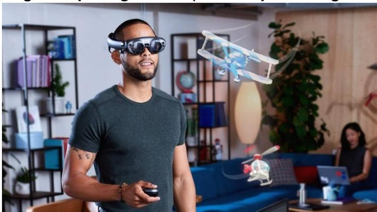
Estas gafas utilizan el sistema operativo Lumin OS y posee nueve sensores diferentes para comprender el espacio en el que se encuentra. Al colocar la potencia de procesamiento en su cadera en lugar de su cabeza, Magic Leap 1 ofrece el rendimiento de una computadora portátil en un dispositivo lo suficientemente ligero (316 g) como para usar todos los días.
