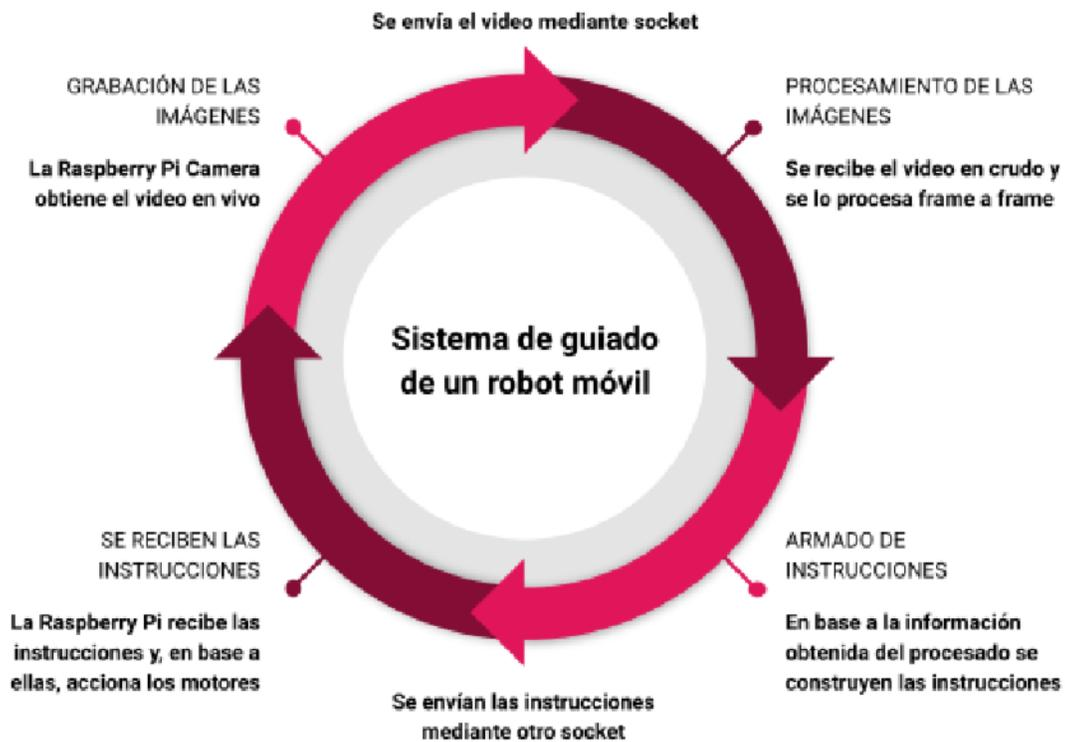
Figura 5.15 - Diagrama del funcionamiento general para guiar al robot móvil. Imagen de mi autoría.
