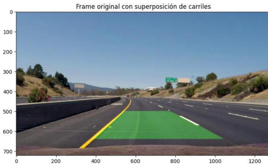
Figura 5.11 - Frame original con superposición de carriles. Imagen de mi autoría.
