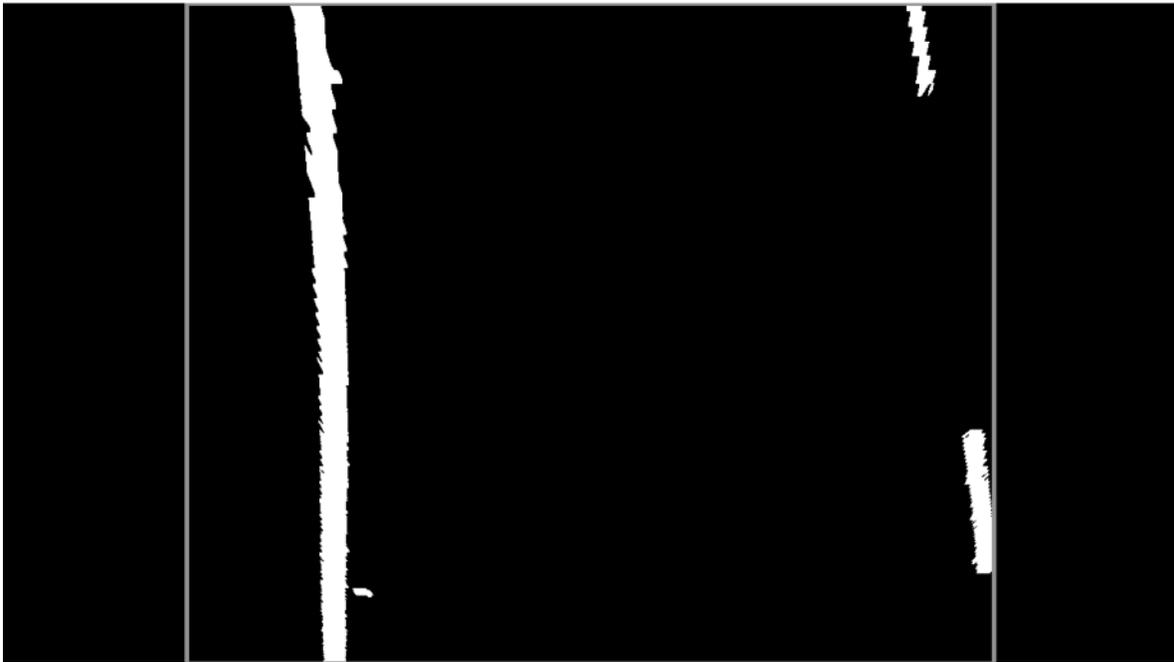
Figura 5.7 - Área del ROI de la imagen deformada con la perspectiva de vista de pájaro. Imagen de mi autoría.
