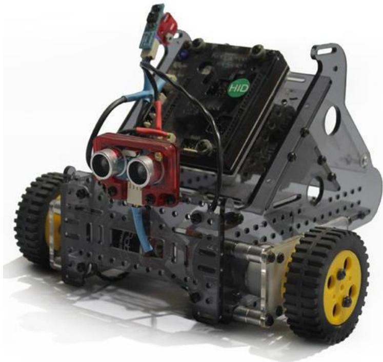
Figura 4.3 - Robot N6, vista delantera. Imagen obtenida del sitio gubernamental de Chubut <https://ciencia.chubut.gov.ar/2016/09/06/talleres-de-robotica-y-programacion-de-videojuegos/>
