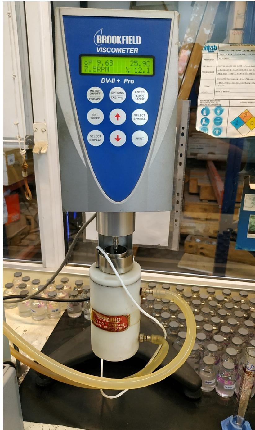
Figura 16 Viscosímetro Brookfield DV-ii + Pro
