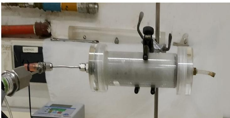
Figura 29 Sand pack con sensor de presión instalado
