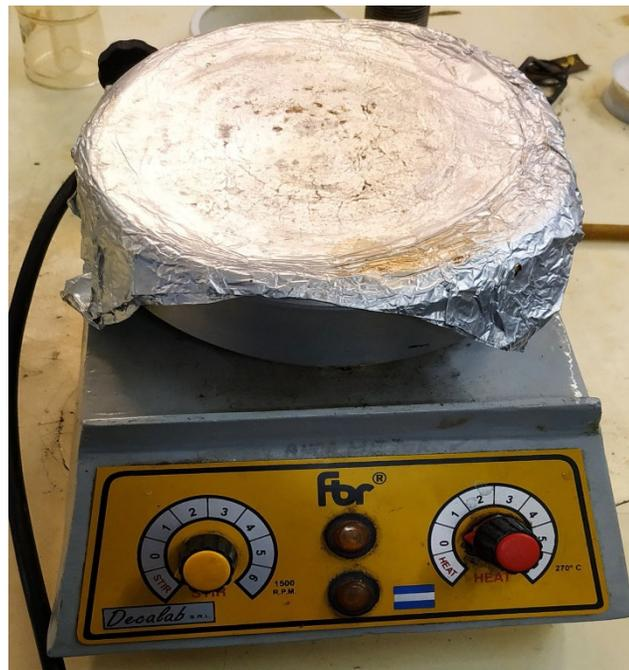
*Figura 12 Agitador magnético*
