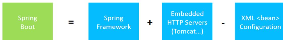
*Ilustración 11: Esquema de un sistema basado en Spring Boot*
