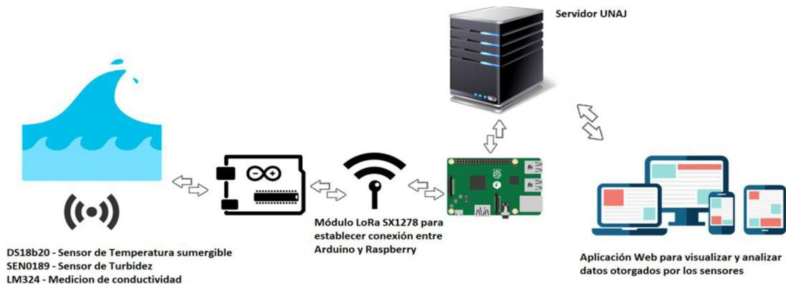
*Ilustración 4: Esquema de la solución general 1
