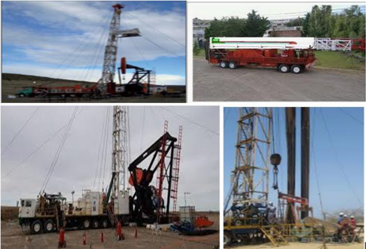
Imagen 1. Equipos de Pulling.
