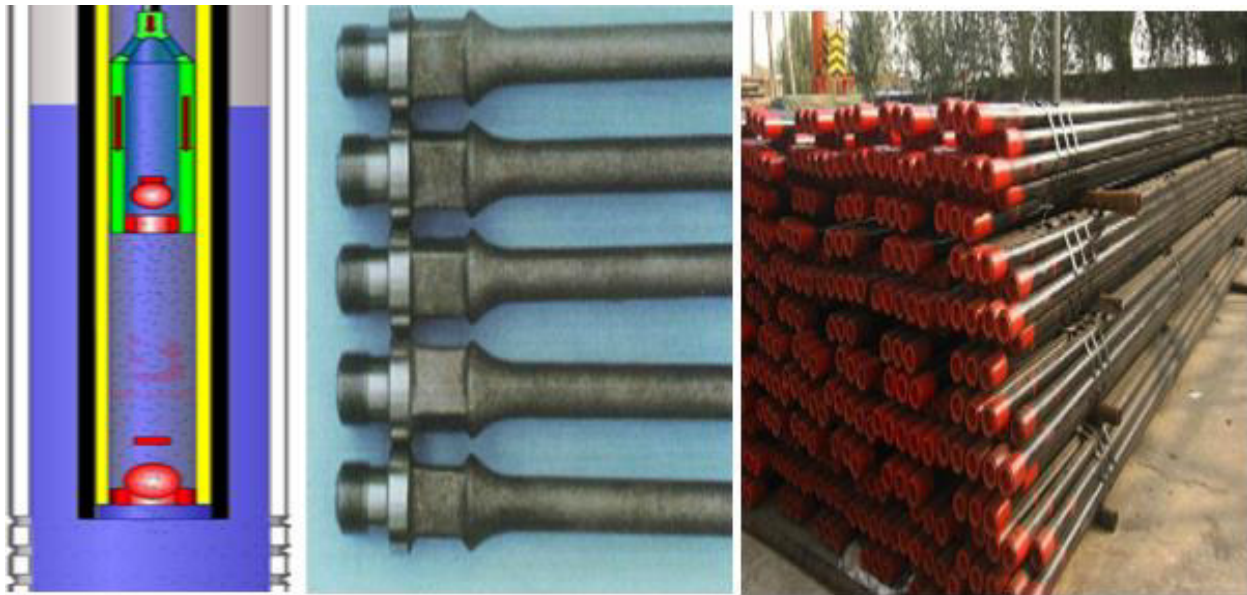
Ilustración 6. Izquierda, Bomba mecánica estándar. Centro, varillas de bombeo mecánico. Derecha, tubings de producción.
