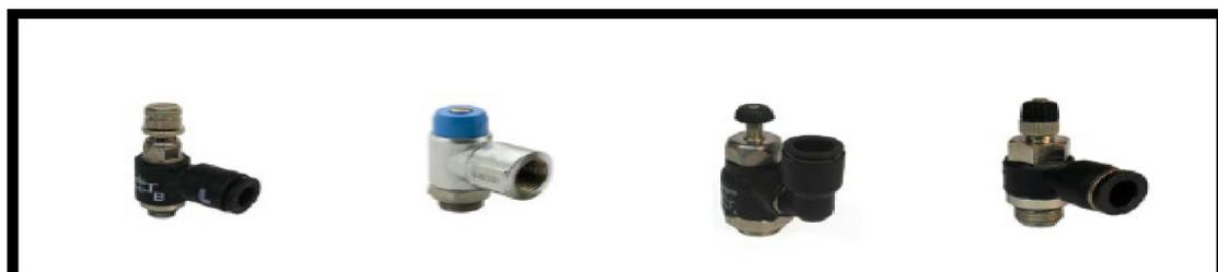
Tipo..... Reguladores de caudal tipo banjo. Se emplean para controlar la velocidad de desplazamiento de los cilindros neumáticos, restringiendo el paso del aire en un solo sentido de circulación del fluido. Los modelos banjo son aptos para montar directamente sobre los cilindros
