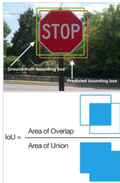
Figura 16. Ejemplo de las áreas de intersección y unión en el par ground-truth bounding box y predicted bounding box (anclaje predicho).
