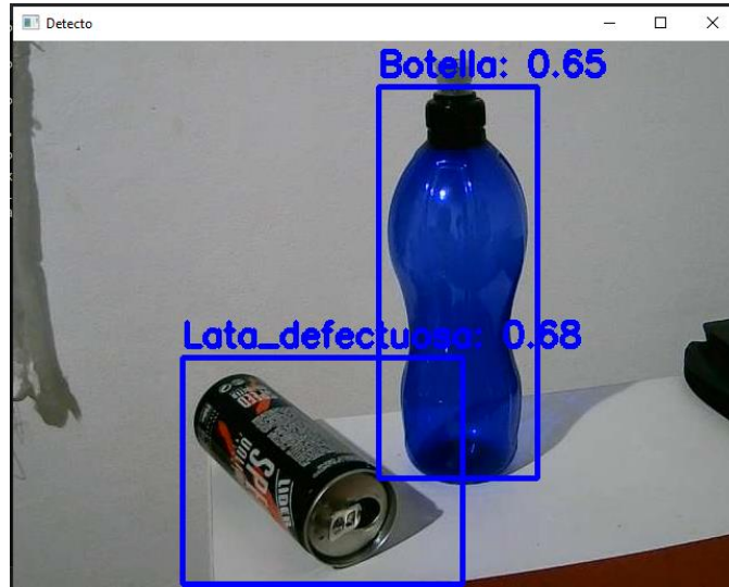
Figura 42. Detección de lata defectuosa y botella.
