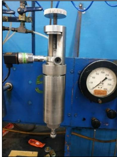
Figura 13. Fotografía celda hassler con sensor de presión instalado (a la izquierda), en el extremo inferior se encuentra el acople para el caudalímetro y en la parte central se halla la conexión para el Nitrogeno.
