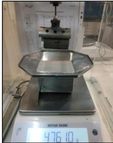
Figura 8. Fotografía del picnómetro con plug dentro del porta muestra.
