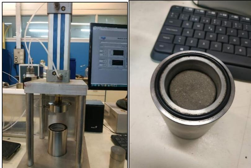
Figura 10. A la izquierda fotografía del porosímetro automático, a la derecha detalle de la celda porta muestra con testigo en su interior.
