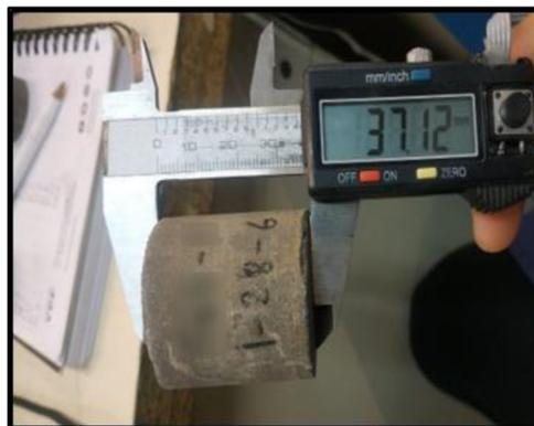
Figura 12. Fotografía de medición longitudinal de plug con calibre.
